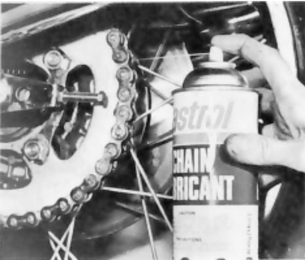
Bild 9 Schmierung der eingebauten Kette mit Sprühdose
