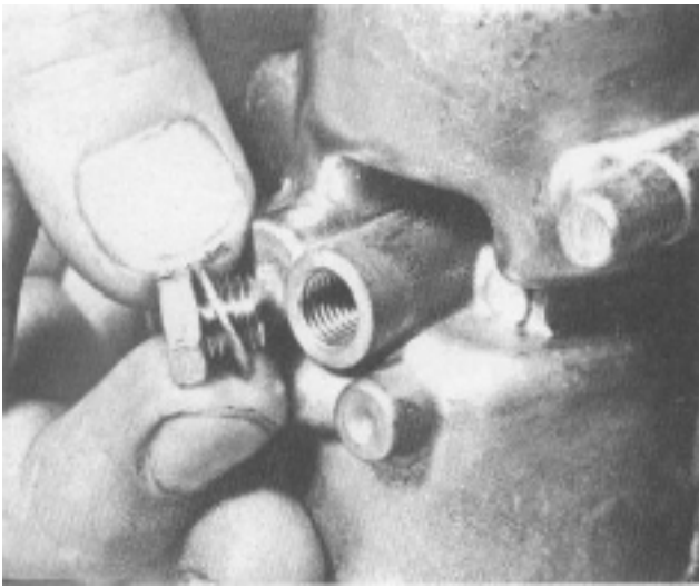
Bild 250 Verschlussstopfen im Boden der Schwimmerkammer entfernen
