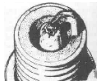
Abgebrannte Elektroden, entweder infolge falschen Wärmewertes oder wegen chronischer Frühzündung (Klingeln)
