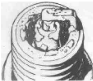
Weisse Ablagerungen und beschädigter Porzellanisolator deuten auf Überhitzung
