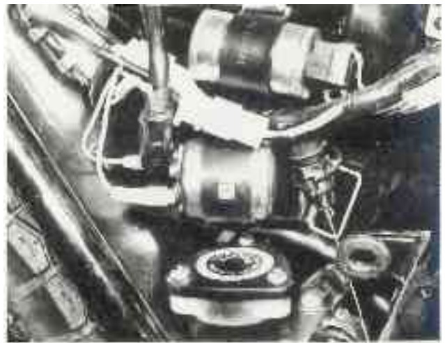
Bild 333 Anordnung des hinteren Hauptbremszylinders (unten im Bild)
