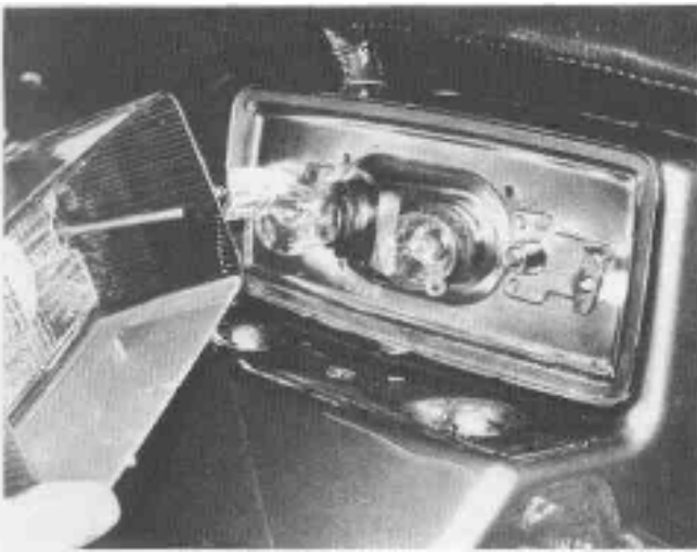
Bild 339 Bremsleuchte mit 2 Glühlampen hinter der Sitzbank der XS500C
